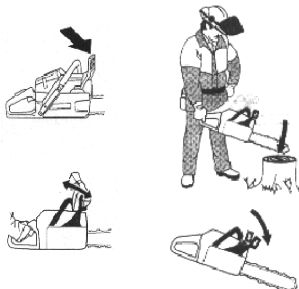
Obr. 13: Kontrola funkce brzdy řetězu
