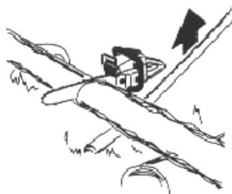
Obr. 6: Uvolnění pily sevřené v řezu
